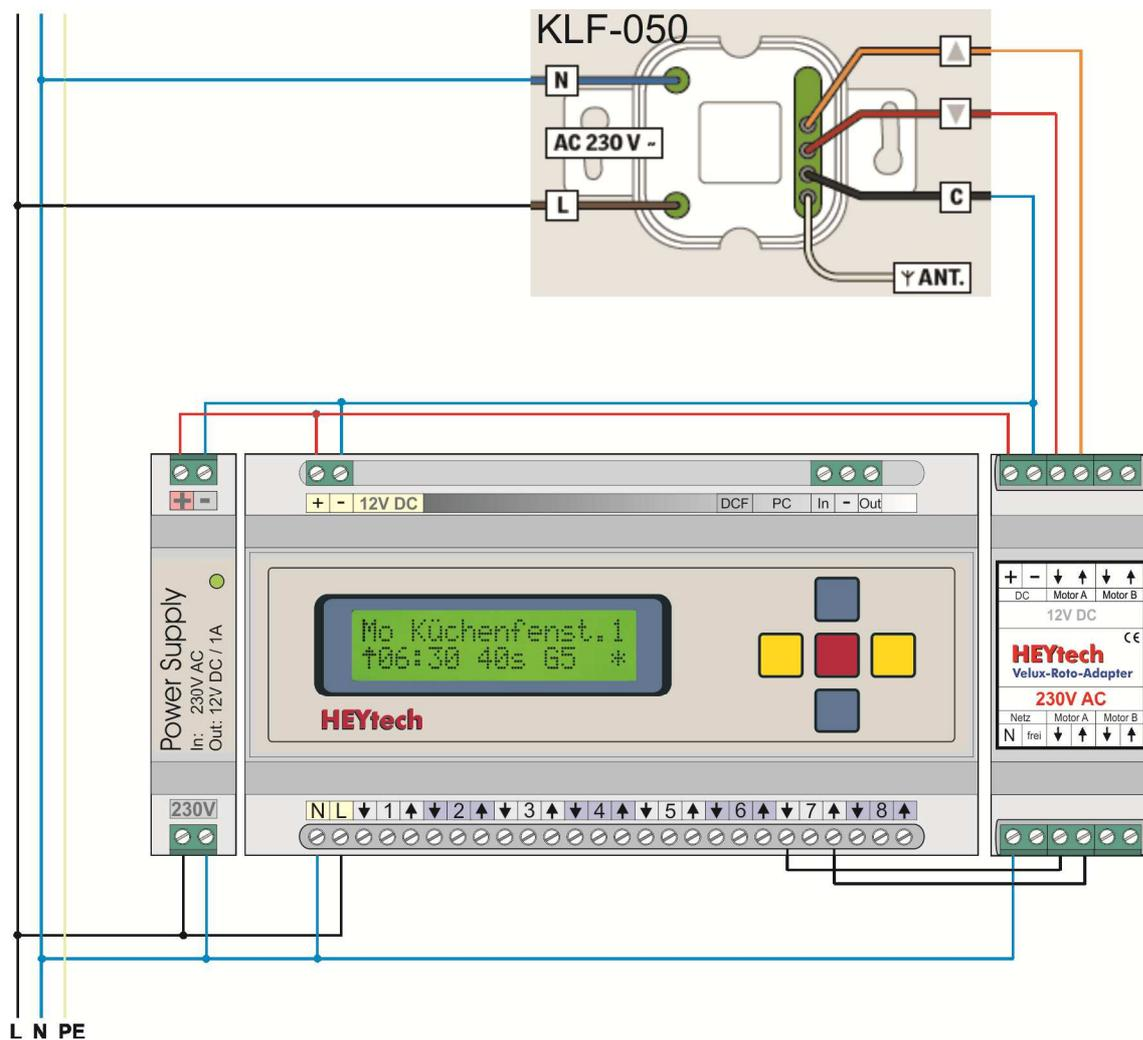
Ein zweites KLF050 Schalterinterface kann über den zweiten Kanal (Motor B) in gleicher Weise angeschlossen werden.
